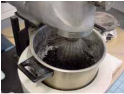
Mengen van het asfaltmengsel.
